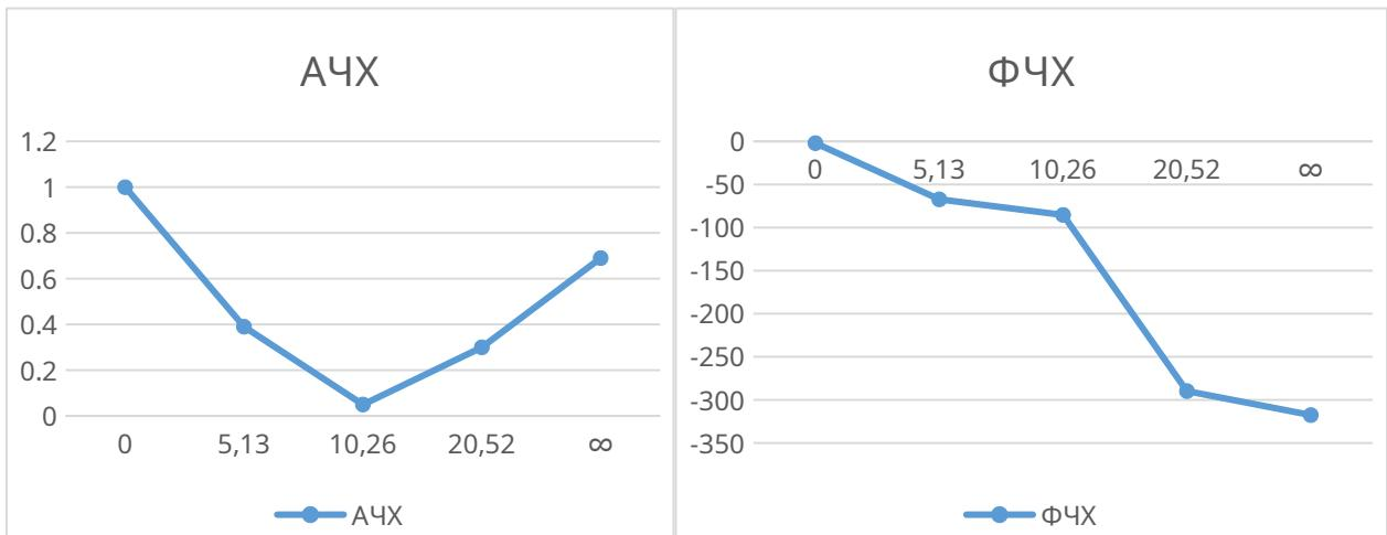
Рисунок 4.5 – АЧХ и ФЧХ двойного Т-образного RC-фильтра.
