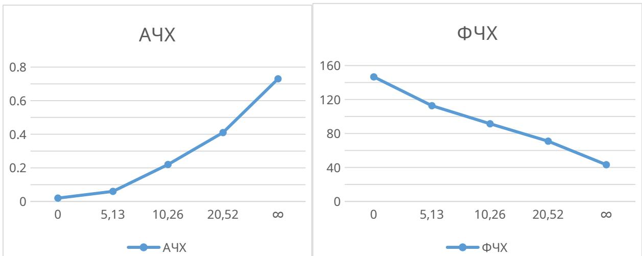
Рисунок 4.4 – АЧХ и ФЧХ для ФВЧ с нагрузкой.
