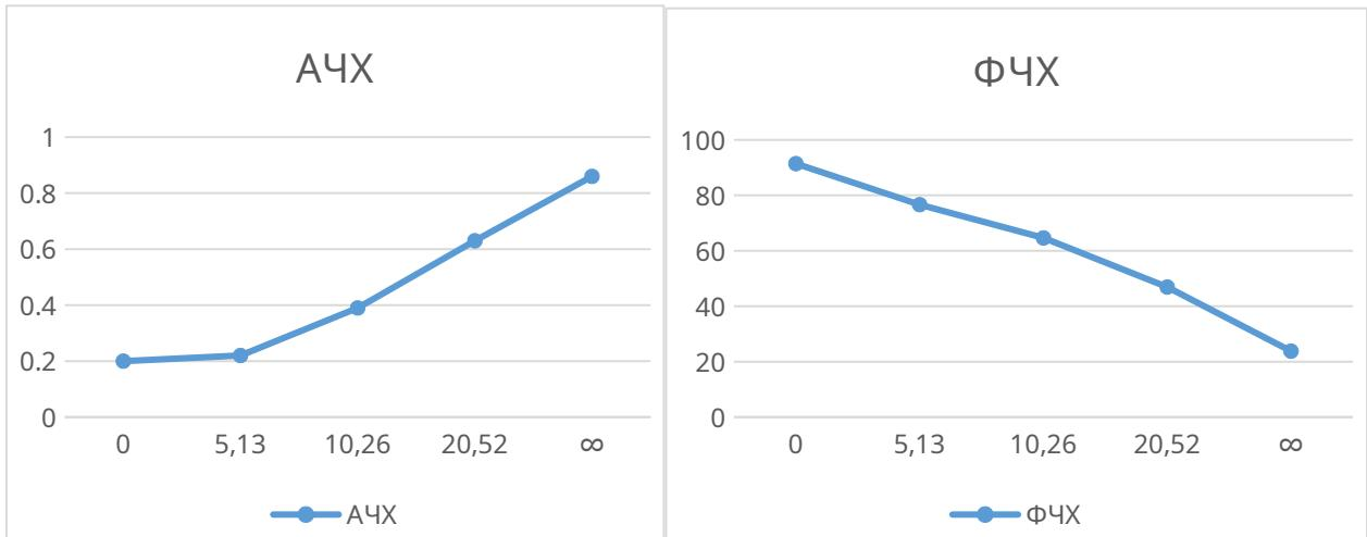
Рисунок 4.3 – АЧХ и ФЧХ для ФВЧ в режиме холостого хода.
