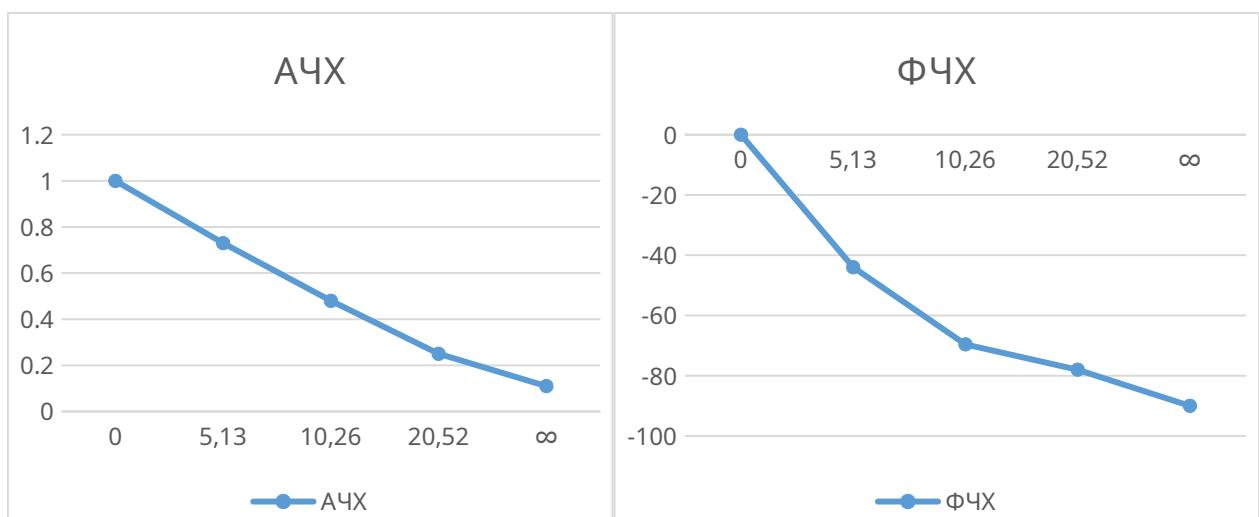
Рисунок 4.1 – АЧХ и ФЧХ для ФНЧ в режиме холостого хода.
