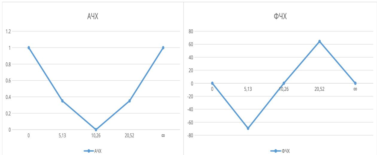
Рисунок 2.1 – АЧХ и ФЧХ режекторного фильтра
