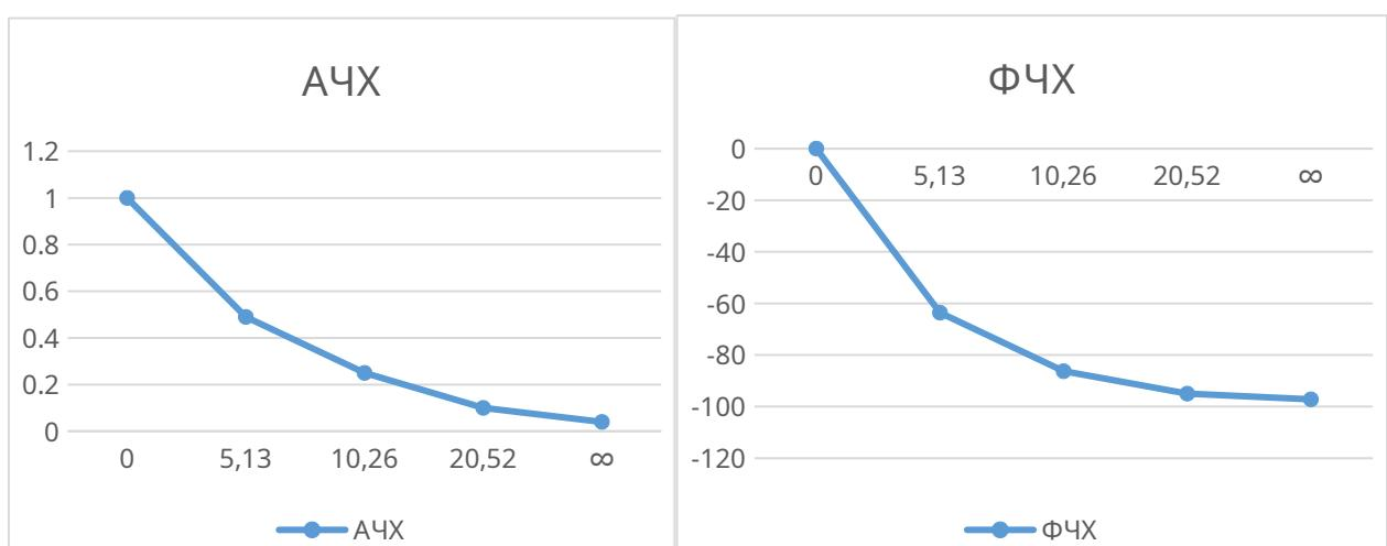
Рисунок 4.2 – АЧХ и ФЧХ для ФНЧ с нагрузкой.
